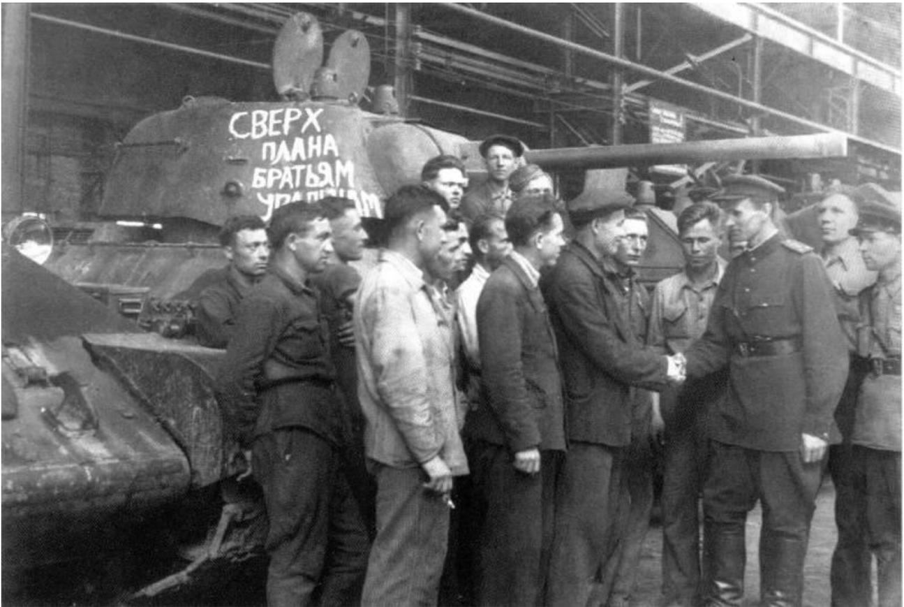
Штампованная башня для танка на снимке выпущена на Уральском заводе тяжелого машиностроения имени Орджоникидзе (УЗТМ) в Свердловске
