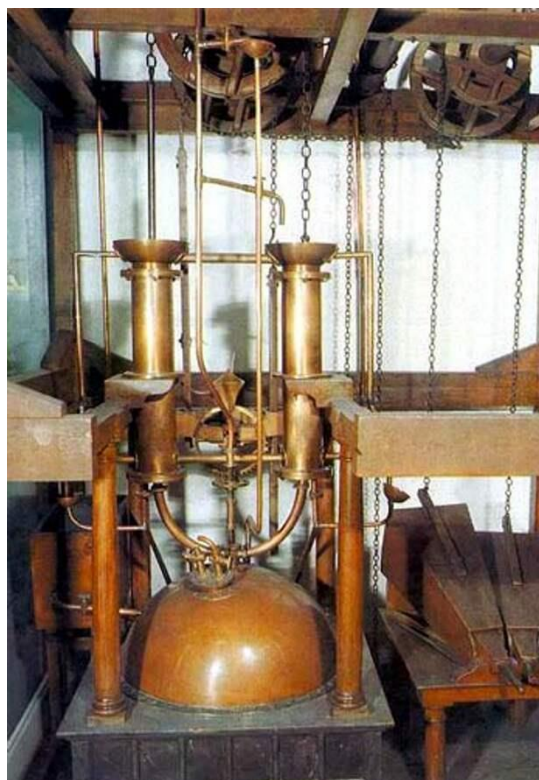
Макет паровой Машины Ползунова
